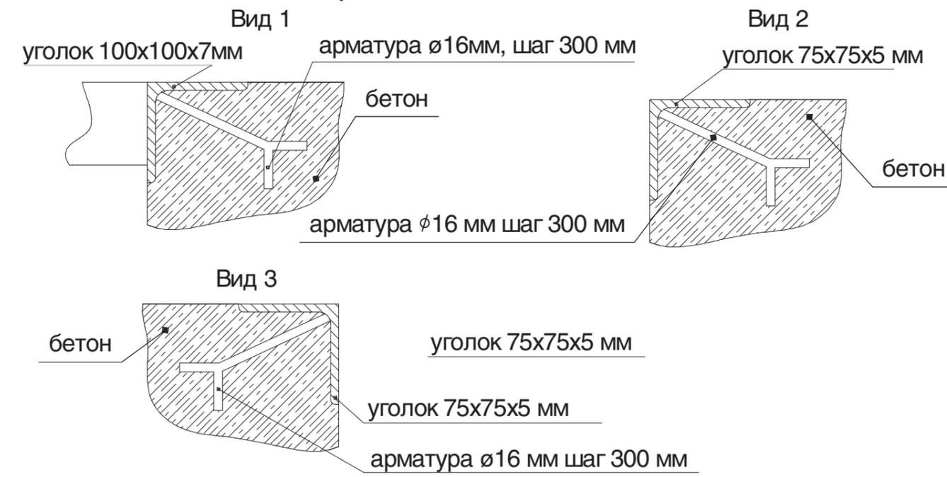
На данном эскизе изображена схема подготовки приямка и установки закладных элементов под уравнильную платформу с поворотной аппаратурой встроенного типа длиной 2000мм шириной 2000мм и высотой 600мм при использовании автомобилей без встроенного лифта
